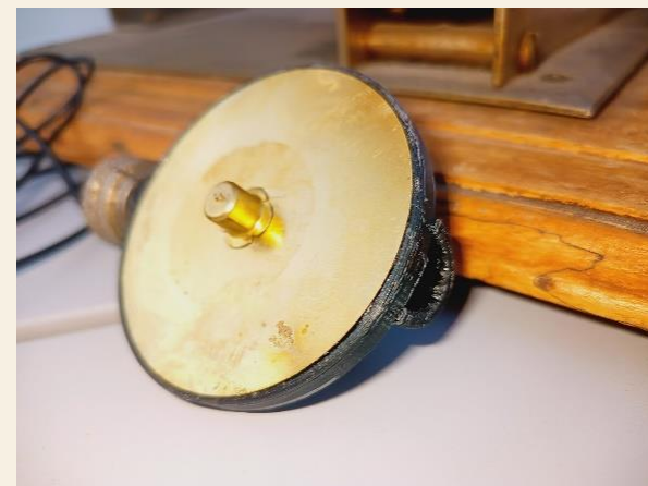
Reproductor piezoeléctrico con chasis impreso en 3D
