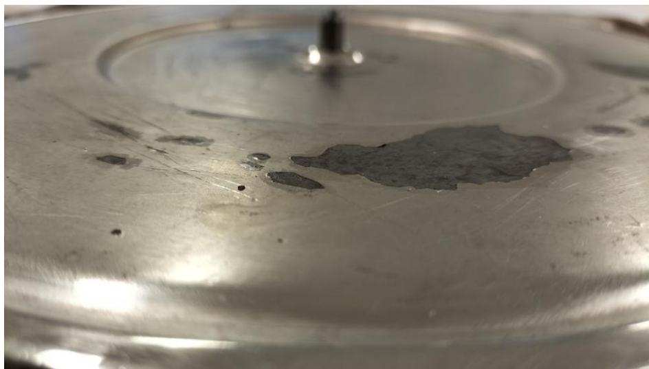
Fig. 79. Detalle de la protección puntual en el plato giratorio con Paraloid® B-44 al 3% en acetato de etilo.
