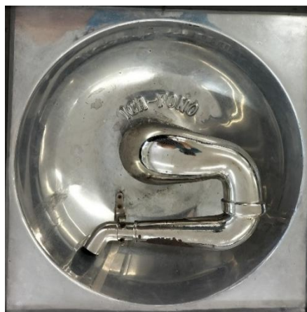
Fig. 65. Reflector parabólico previo a la limpieza de polvo.
