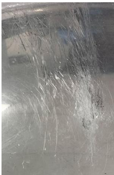
Fig. 77. Detalle de los arañazos en el reflector parabólico, previo a la protección.
