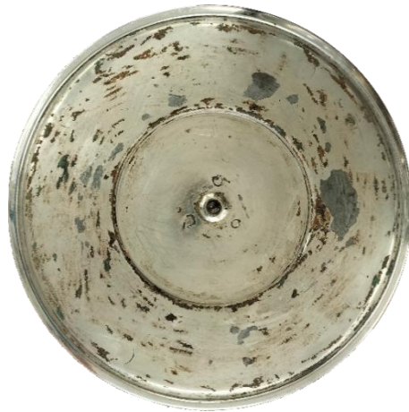
Fig. 70. Plato giratorio tras una primera limpieza de los restos más finos con alcohol etílico.
