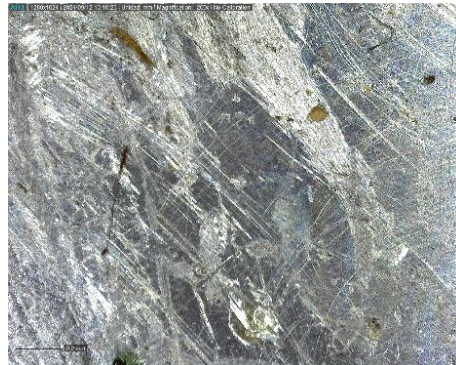
Fig. 44. Detalle a microscopio digital (x200) del rayado del reflector parabólico.
