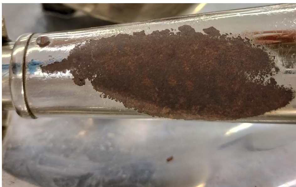
Fig. 35. Detalle de la oxidación del tubo móvil del reflector parabólico.
