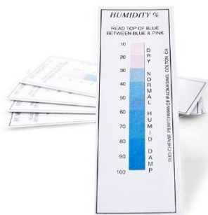
Fig. 90. Ejemplo de tiras indicadoras del nivel de humedad presente.
