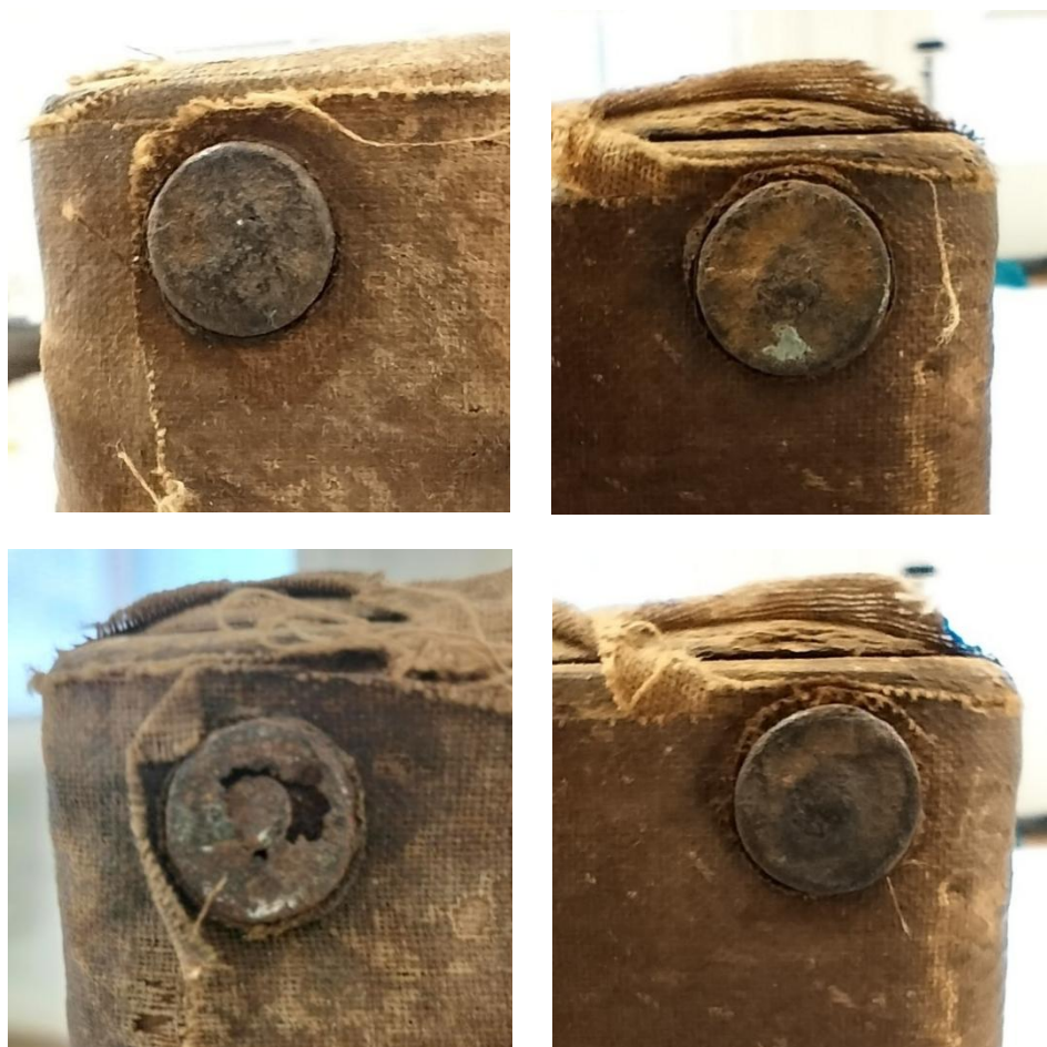
Fig. 80, 81, 82 y 83. Estado de los clavos con embellecedores previo a su extracción
