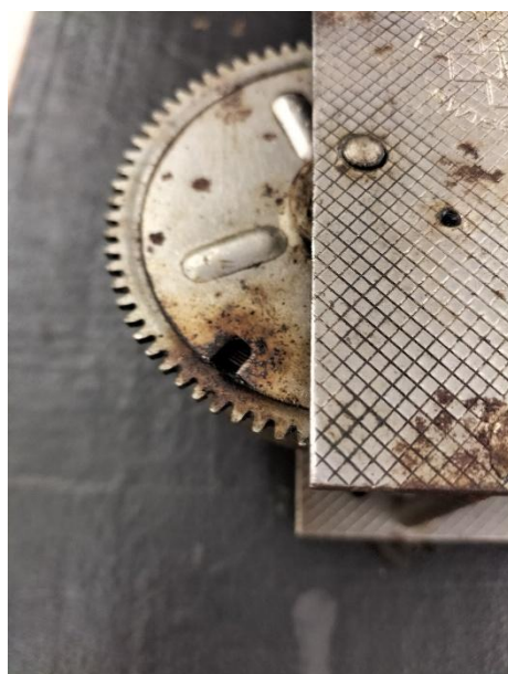
Fig. 51. Detalle tras la limpieza de la grasa envejecida con alcohol etílico y acetona en el motor.
