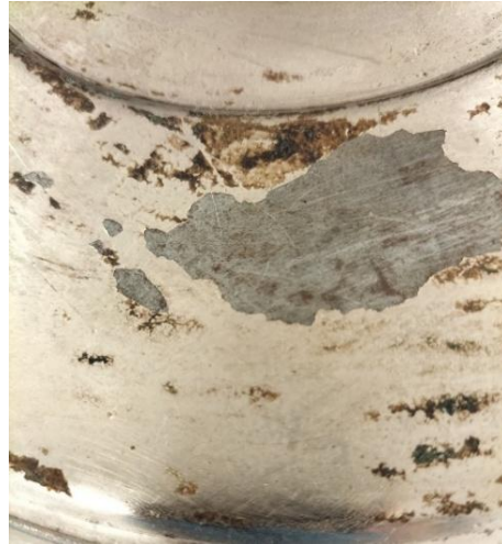
Fig. 67. Adhesivo envejecido previo a la limpieza con solvent gel .
