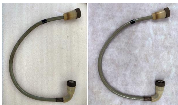
Fig. 6. Antes y después del proceso de limpieza del recubrimiento del cable con sistemas acuosos.
