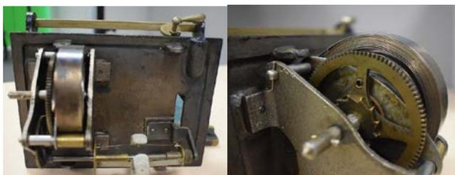
Figura 5 – Detalles del engranaje de relojería.
